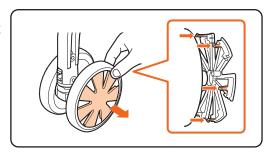
用手指按壓車輪内側,拆下所有的固定勾爪(前輪7處、後輪6處),然後將輪罩拆下。 輪罩被拆下時可能會飛出,所以拆卸時請按住輪罩。如果强行拉拔拆卸,會導致固定勾爪損壞。請注 意不要弄傷手指或指甲。
