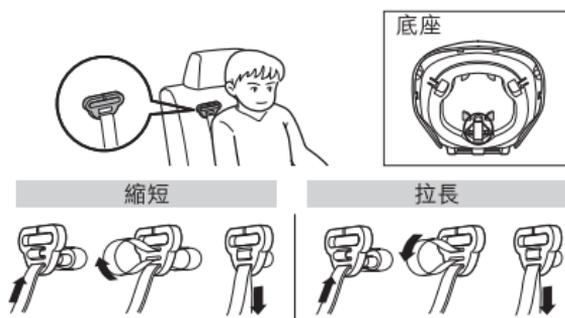
**2** 拉出車子的安全帶，然後將肩帶穿過肩帶輔助器、腰帶穿過腰帶導引（在扶手底下），確認扣子扣緊，聽到卡嗒一聲如圖示。
