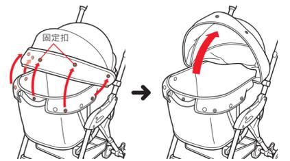
使用時請務必關閉遮陽篷，確認固定扣已扣上，確實閉合，否則可能造成寵物掉落等意外事故。
