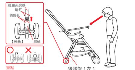
**重點** 如果發現安裝錯誤的車輪並且銷釘已進入車架，請使用細棒或類似工具將車架內的銷釘恢復到其原始位置。
