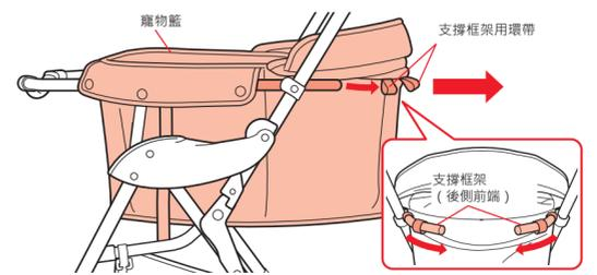
拆卸寵物籃時，請務必使用車輪鎖定桿，否則可能發生寵物推車滑動等意外事故。
