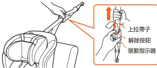
**7** 將上拉帶掛鉤固定在汽車內的上拉帶固定錨點上。
