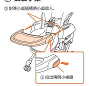
③輕輕前後推動小桌,確認牢固後才開始使用。 安裝小桌前先鎖上搖擺鎖,小桌可作出三段
