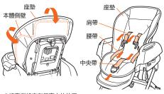
①將靠背設定在最直立的位置。 ②把座墊放在本體上,從座墊的前面抽出(各部安全帶)。 ③把左右的橡皮圈掛在本體兩側的吊鉤上。 ※調節肩、腰帶時應保留1-2個成人手指的空隙
