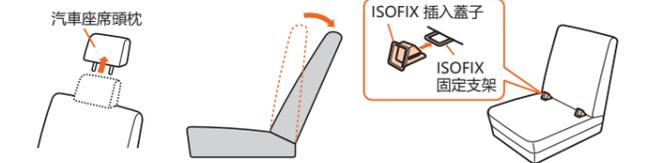
\*安裝兒童汽車座椅無需拆卸座席，拆卸後安裝會變得更加容易。如在未拆卸的情況下安裝，安裝方法請參閱 2.1，座椅前後向兩種使用方式安裝方法相同。
