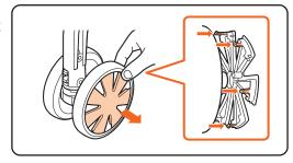
用手指按壓車輪内側,拆下所有的固定勾爪(前輪7處、後輪6處),然後將輪罩拆下。 輪罩被拆下時可能會飛出,所以拆卸時請按住輪罩。如果强行拉拔拆卸,會導致固定勾爪損壞。請注 意不要弄傷手指或指甲。
