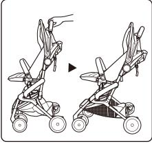
① 如圖中箭頭方向拉動安全鎖作解除。
